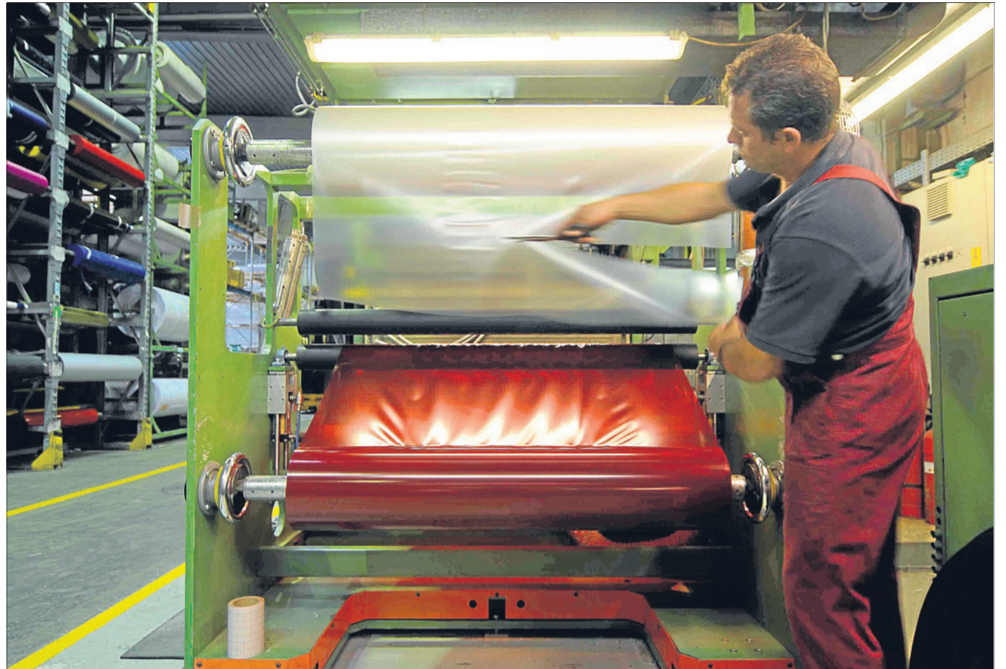
Folien sind das Markenzeichen von Aslan. Auf großen Rollen und Walzen wird produziert. (Foto: Aslan)
